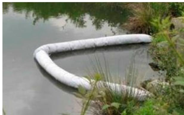
**Material para contención de derrames.** Se pueden encontrar en el mercado varios materiales para absorción de diferentes sustancias químicas. Es necesario contar con al menos el kit de derrames de hidrocarburos, el cual puede utilizarse en tierra y en agua. Se muestran algunos ejemplos de los kit para derrames y los links donde pueden adquirirse.
